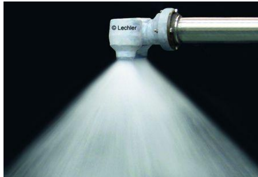
21. ábra: Füstgáz kéntelenítőben alkalmazott mészkő szuszpenzió bepermetezése [forrás: http://www.hennlich.by/typo3temp/pics/TwinEV_a92df7e190.jpg ]
